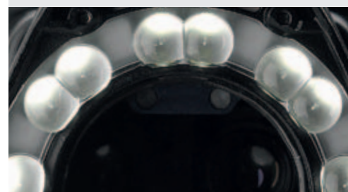
Le lenti di messa a fuoco della luce anulare ottimizzano luminosità e distribuzione
