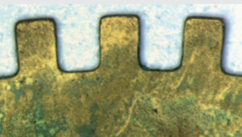
Ossidazione su una ruota dentata
