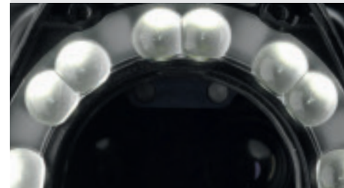
Die Fokuslinsen des Ringlichts optimieren Helligkeit und Ausleuchtung
