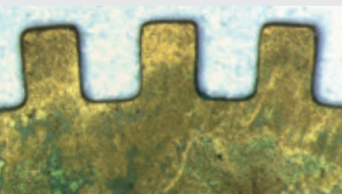
Oxidación en una rueda dentada
