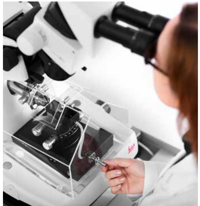
물 흐름 양을 조절하기 위해 ARTOS 3D의 앞에 있는 밸브를 간단히 조절함으로써 리본에 주름이 생기는 것을 피합니다. 또한 ARTOS 3D의 외풍 보호막과 능동 완충판(active damping plate)으로 보다 일관된 절편 두께를 얻게 합니다.
