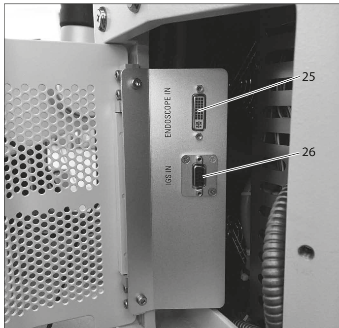
25 DVI In fra endoskopkamera (HDMI-kompatibel) 26 XGA in fra IGS-systemer
