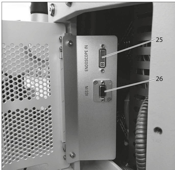
25 DVI In endoskoopin kamerasta (HDMI-yhteensopiva) 26 XGA in IGS-järjestelmistä
