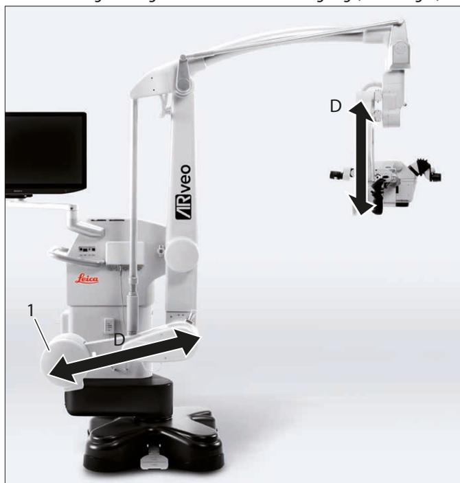
Wenn ein Ausbalancieren in Richtung D nicht möglich ist, muss eine Gewichtsscheibe hinzugefügt oder entfernt werden, siehe Abschnitt 7.6.4.
