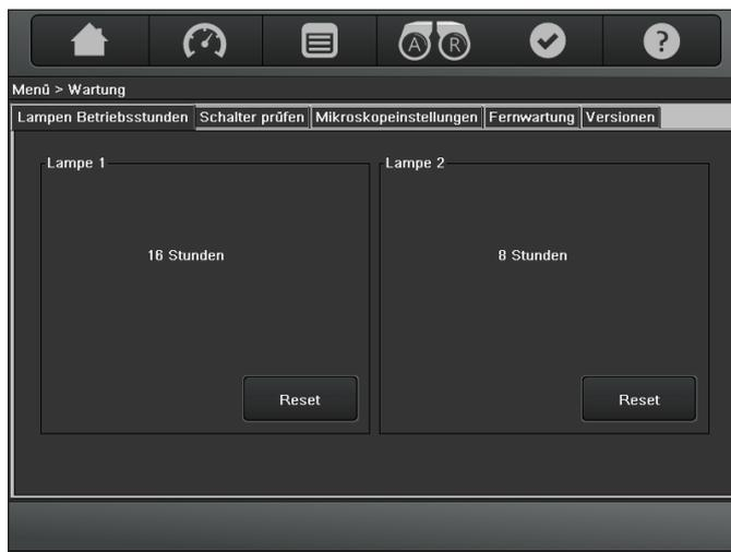
**!** Setzen Sie nach jedem Lampenwechsel den jeweiligen Betriebsstundenzähler durch Doppelklick auf die "Reset"-Taste auf 0 zurück.
