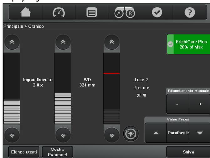
Quando BrightCare Plus è attivato, la linea rossa della barra per la regolazione della luminosità indica il limite della luminosità massima impostabile per la distanza di lavoro corrente. La luminosità non può essere regolata oltre la linea rossa a meno che la funzione BrightCare Plus sia disattivata internazionalmente. Quando la distanza di lavoro risulta eccessivamente ridotta per la luminosità impostata, questa si riduce automaticamente.
