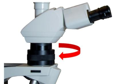
**Le module ergo télescopique** entre le pied et le tube d'observation permet d'ajuster facilement la hauteur du microscope.
