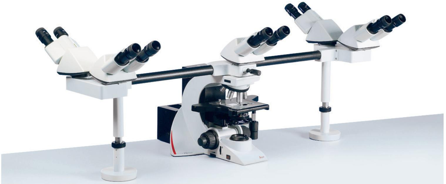
Les systèmes à collecteurs multiples sont flexibles et très modulaires. Ils se fixent à un seul microscope, et permettent la visualisation simultanée d'images haute résolution du même spécimen en direct.
