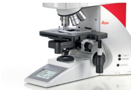
**Conception ergonomique** : Les commandes d'agrandissement et de mise au point faciles, ainsi que le mouvement entièrement automatique de la tête du condenseur vous permettent de travailler en tout confort..
