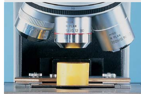
Sempre la giusta regolazione dei diaframmi con l'anello obiettivi con codifica tramite colori
