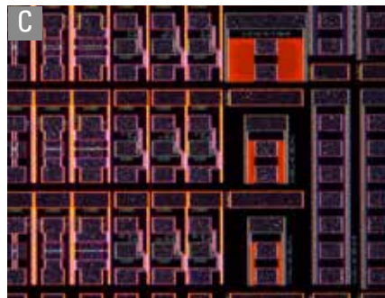
ウェハ試料の画像取得： A) 10x 微分干渉コントラスト (DIC) B) 100x 明視野 (BF) 斜照明 C) 5x 暗視野 (DF)
