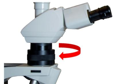
**Das höhenverstellbare Ergomodul** zwischen Stativ und Tubus ermöglicht die einfache Einstellung der Höhe des Mikroskops.
