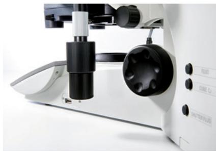
**Intelligente Automatisierung:** Umschaltung mit einem einzigen Tastendruck zwischen den Kontrastmethoden ermöglicht einen schnellen und einfachen Wechsel von Hellfeld zu Fluoreszenz.
