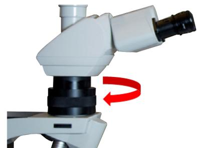
**Il modulo ergonomico telescopico** tra lo stativo e il tubo di osservazione permette di regolare l'altezza del microscopio con facilità.
