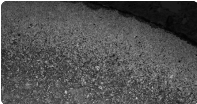
经过脱碳处理的钢结构。样品来自电机机轴。
