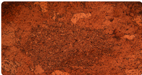
Beobachtung der Mikrostruktur eines Statorkupferdrahtes.
