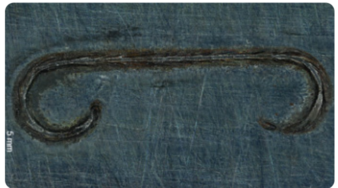
Imagen de una pieza soldada por láser que podría utilizarse en una carrocería de vehículo eléctrico.
