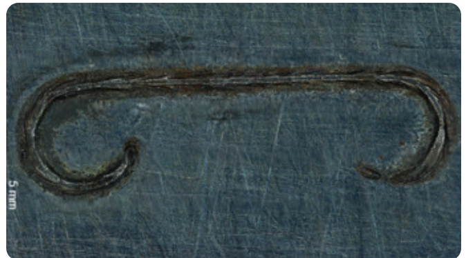
Image d'une pièce soudée au laser qui pourrait être utilisée dans une carrosserie de véhicule électrique.
