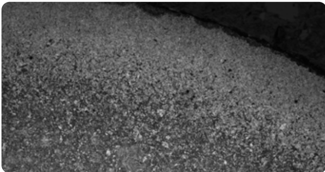
Struttura in acciaio sottoposta a decarburazione. Il campione proviene da un albero del motore elettrico.
