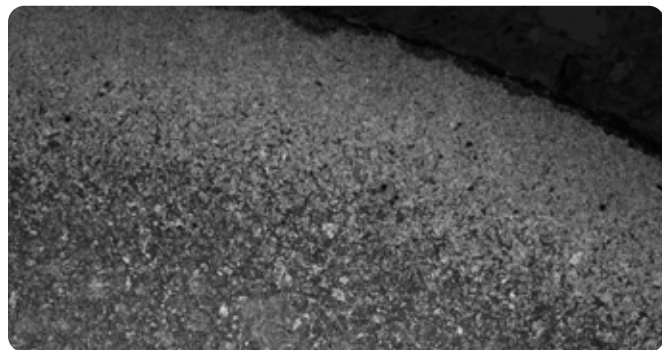
脱炭処理されたスチールの構造。サンプルは電気モーターシャフトから得られたものである。
