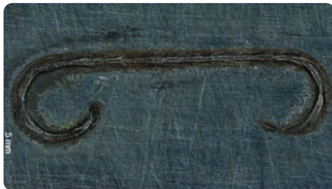
EV ボディに使用できるレーザー溶接部品の画像。
