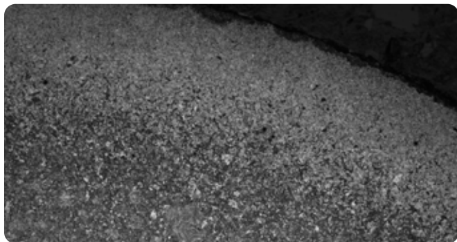
Estrutura de aço que foi submetida a descarburização. A amostra é de um eixo de motor elétrico.
