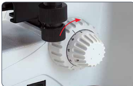
Manopola di regolazione macrometrica della messa a fuoco
