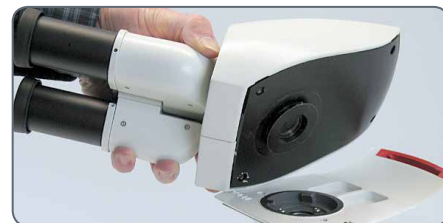
Tipo 2: tubo di osservazione standard con oculari separati
