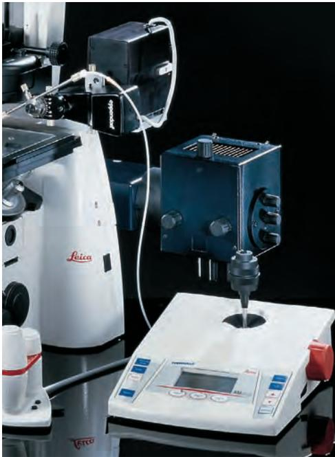
Leica AM6000\* 是显微操作应用的系统解决方案。它能满足最苛刻的显微操作要求。通过与Eppendorf的密切合作，AM6000可以达到最高层次显微操作功能，使Eppendorf显微操作与Leica DMI6000 B倒置显微镜融为一体，使显微镜操作如此容易。
