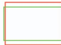
Das Leica DMS300 besitzt für das Livebild auf einem HD-Monitor einen Bildausschnitt im Format 16:9 (dargestellt mit einem grünen Rahmen). Die Aufnahmen werden immer im Format 4:3 gespeichert (dargestellt mit einem roten Rahmen).
