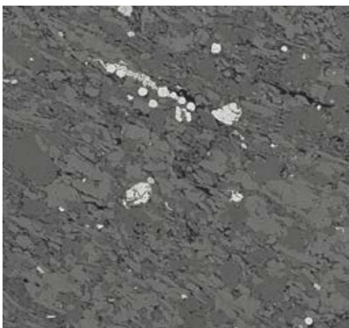
油页岩(纳米孔隙)，经Leica EM TIC 3X(旋转样品台)制备
