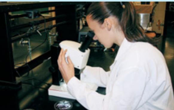
製造検査工程で行われる実体顕微鏡による目視検査・良否判定等作業性の向上は、生産性に影響する重要な改善項目です。
