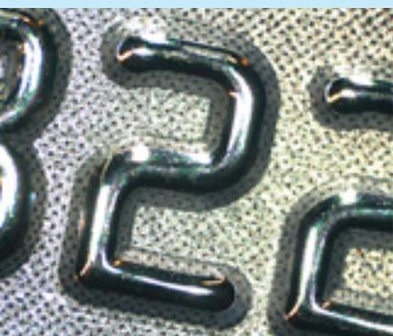
上部3灯による傾斜落射照明
