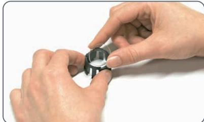
4. ホルダを接眼レンズに再び挿入します。タイプに応じて、ホルダを押し込むか、ねじって所定の位置にする必要があります。
