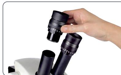
6. 鏡筒内で接眼レンズを回してレチクルの位置を調整します。
