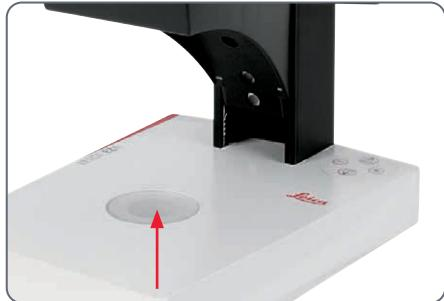
2. 落射光 / 透過光 2 つの LED 照明のいずれか、あるいは両方点灯または消灯します。
