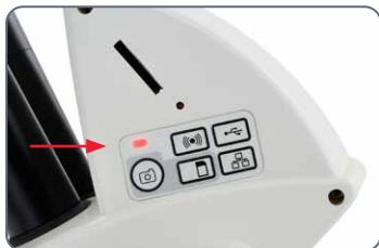
3. SD 모드 이외의 모드 버튼에 녹색불이 들어오면 SD 모드 버튼을 누르고 상태 LED와 SD 모드 버튼에 녹색불이 들어올 때까지 기다리십시오.
