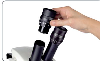
6. Rikta in streckplattorna genom att vrida på okularet i tubröret.
