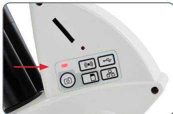
3. Skulle någon annan driftlägesknapp än den för SD-läget lysa grön, får du hålla SD-lägesknappen intryckt tills både statuslysdioden och SD-lägesknappen blir gröna.
