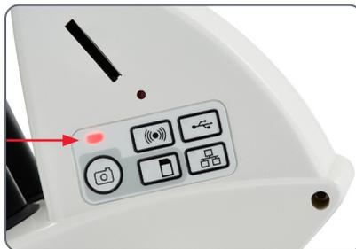
4. Skulle någon annan driftlägesknapp än den för Ethernet-läget lysa grönt, får du hålla Ethernet-lägesknappen intryckt tills både statuslysdioden och lysdiodknappen för Ethernet-läget lyser grönt.
