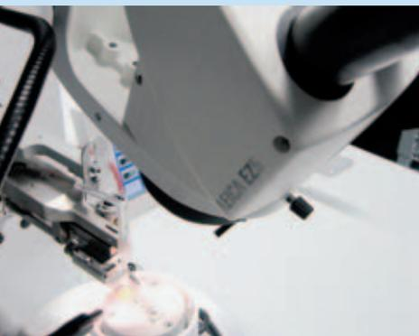
Il Leica EZ5 montato su un robot di saldatura
