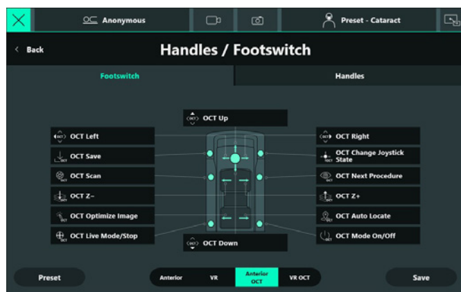
Benutzeroberfläche des Proveo 8x mit Fußschalter- und Griffprogrammierung. Einfache Bedienung via 27-Zoll-2D-4K-Touchscreen-Monitor oder 10-Zoll-Bedienfeld am Tower.
