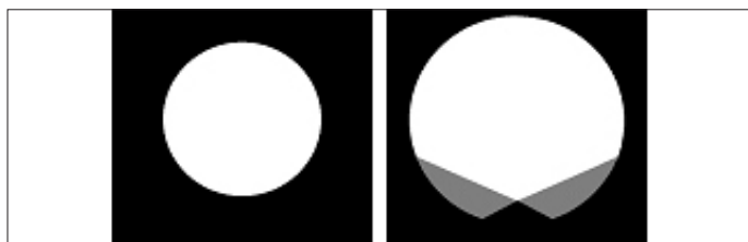
Náčrty osvětlovacích vzorů pro kruhové (vlevo) a pruhové (vpravo) masky odlesků.
