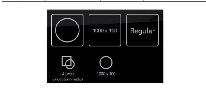
1. Forma: rectangular, radial o lineal (adquiere la misma línea repetidamente a lo largo del tiempo).
