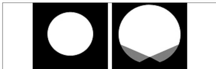
*Esquemas de patrones de iluminación para el filtro antideslumbramiento circular (izquierda) y de barra (derecha). Las áreas grises del esquema del filtro de barra representan las zonas que reciben solo el 50 % de la iluminación.*
