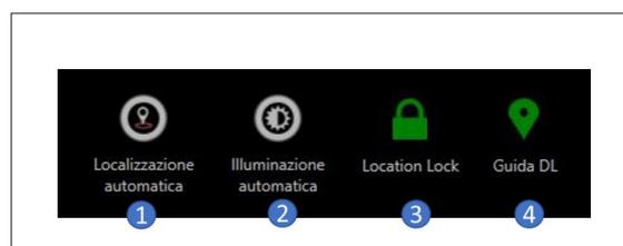
1. **Localizzazione automatica:** regola automaticamente la scansione al fine di trovare la superficie target più luminosa nell'intervallo assiale per la procedura selezionata. Può essere attivata dallo schermo o dalla pedaliera; una volta attivata, l'icona mostra l'opzione per interrompere la funzione e annulla automaticamente la ricerca. Se la posizione del microscopio è cambiata mentre era la funzione era attivata, quest'ultima viene automaticamente interrotta.
