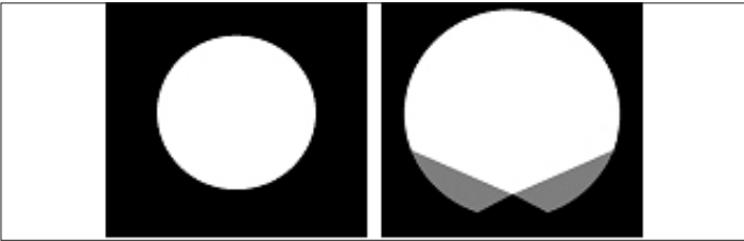
Afbeelding van verlichtingspatroon voor rond (links) en recht (rechts) antiverblindingsmasker. De grijze gebieden in de afbeelding geven gebieden aan die 50% worden verlicht.
