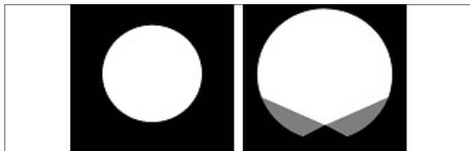
Skisser av belsningsmønster for sirkulære (t.v.) og stangformede (t.h.) blendingsmasker.
