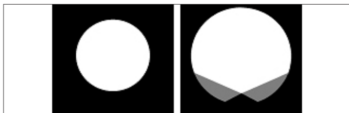
Rysunek wzoru oświetlenia dla maski okrągłej (po lewej) i paskowej (po prawej).
