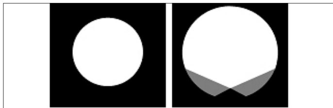
Skisser över belysningsmönster för bländskydd av cirkulär modell (vänster) och modifierad stång (höger).
