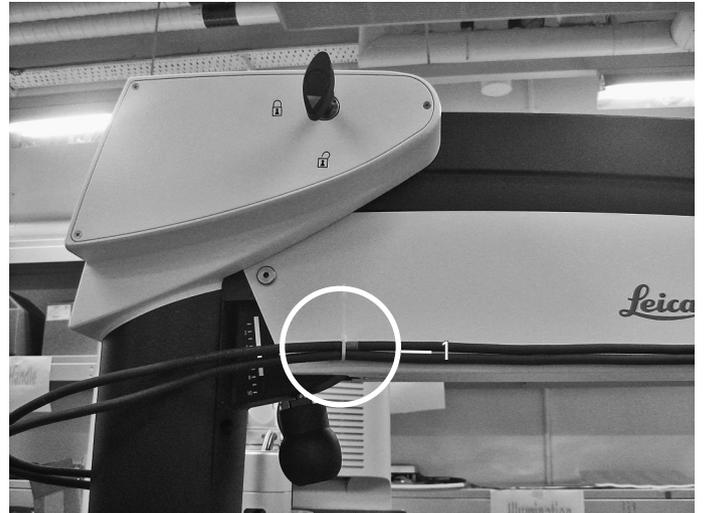
⇒ Y-Kabel FL800 und VGA-Kabel bei den roten Markierungen an der Kabelhalterung befestigen (1).
