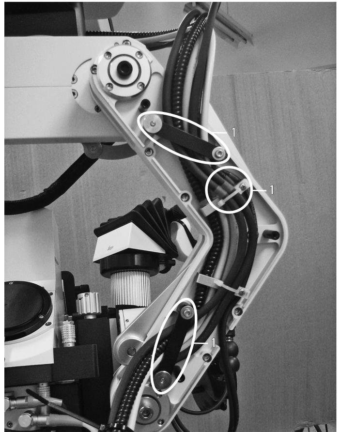
⇒ Y-Kabel FL800 und VGA-Kabel unter die Kabelschienen führen und mit Kabelbindern an den Kabelhalterungen befestigen.
