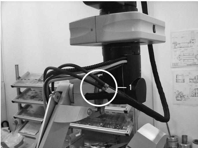
⇒ Y-Kabel FL800 und VGA-Kabel an der roten Markierung in die zweite Kabelführungsschiene 1074363 einrasten und Gewebeschauch 10743363 darüberziehen (1).
