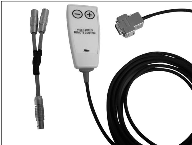
⇒ Handschalter für motorische Feinfokussierung am Steuergerät des F50 (interner CAN-Bus) einstecken.
