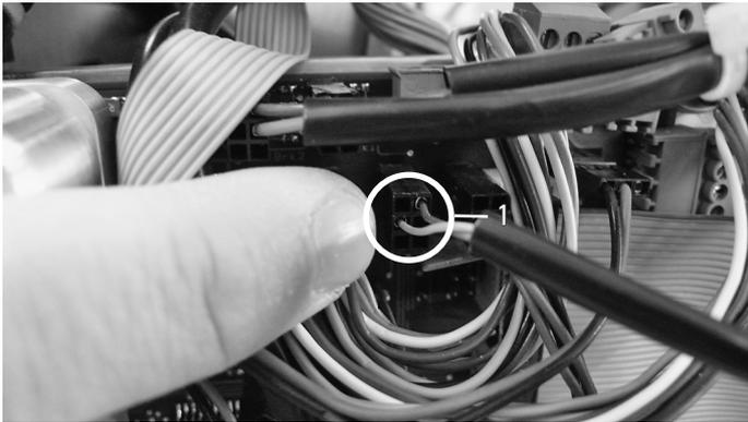
⇒ Y-Kabel FL800 (10717885) an Control Board und Connector Board (1) anschließen.
