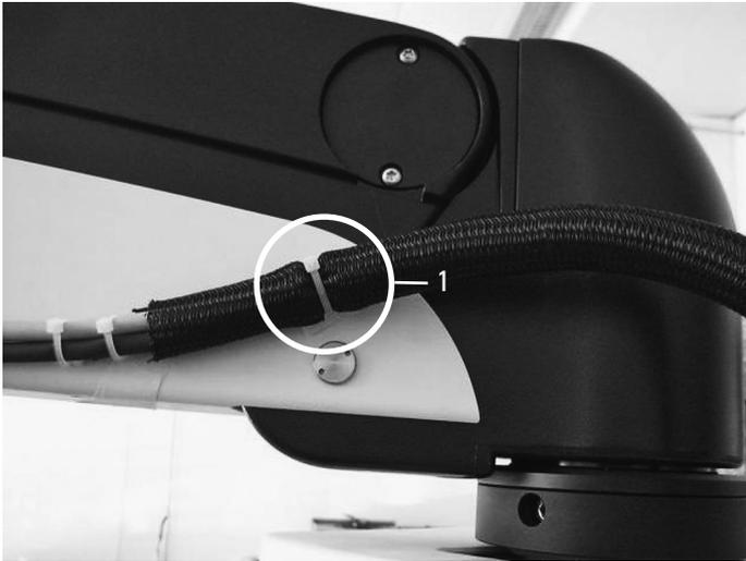
⇒ Längeren Teil des Gewebeschauchs 10743363 anbringen und mit einem schwarzen Kabelbinder an der Kabelhalterung befestigen (1).
