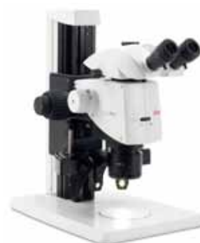
Lo stereomicroscopio modulare Leica M125 offre uno zoom 12.5:1 apocromatico totalmente corretto. Il vasto campo di zoom permette sia la panoramica su un campione, sia l'osservazione delle strutture più fini con una risoluzione massima di 1.15 \mu\text{m} .
