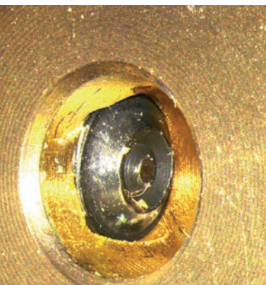
Leica LED5000 NVI: Fotografía interior de un tornillo prisionero en una rueda dentada de latón
