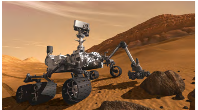
火星探査ローバー「Curiosity」に装備された LIBS 分光分析装置 画像提供: NASA/JPL-Caltech (NASA ジェット推進研究所、カリフォルニア工科大学)
