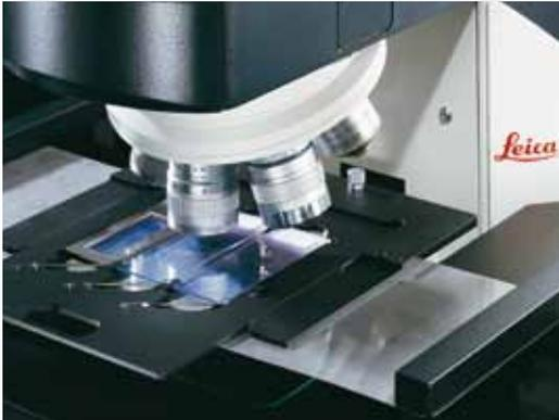
这里的三片型样品夹适用于三片载玻片自动操作，对于不同的应用方向还可选配不同的样品夹。
