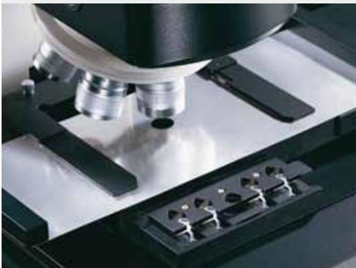
全自动可移动收集盘便于收集目标。这种全自动收集盘还可以兼容各种用户自制的装置。
