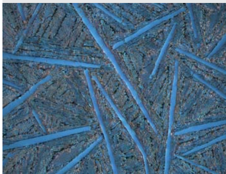
Ferro greggio ipereutettico bianco, cementazione primaria, luce polarizzata 100 x
