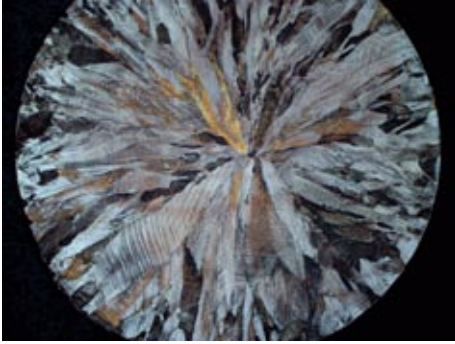
銅・亜鉛棒材、対物レンズ PLAN FLUOTAR 2.5 ×、 偏光
