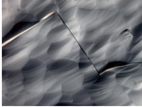
太陽電池、PLAN FLUOTAR 50 ×、 傾斜照明
