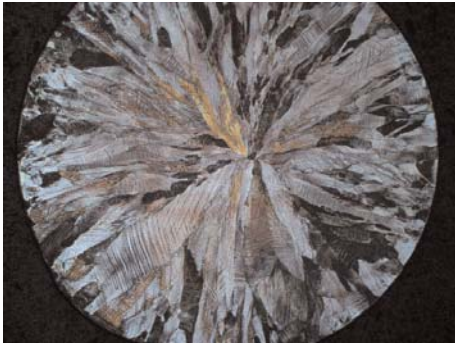
Tige en alliage cuivre-zinc, PLAN FLUOTAR 2,5x, Pol
