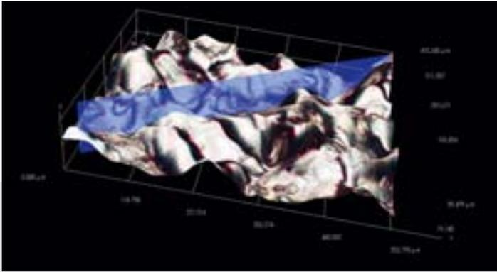
Mit modernen Digitalmikroskopen ist 3D-Profiling in allen Varianten möglich: 3D-Profile von Höhen, Breiten und Oberflächenstrukturen; Darstellung als Textur, Farbhöhenkodierung oder Gitternetzmodell; Höhendifferenz- und Volumenmessungen; kombiniertes 2D- und 3D-Profiling.
