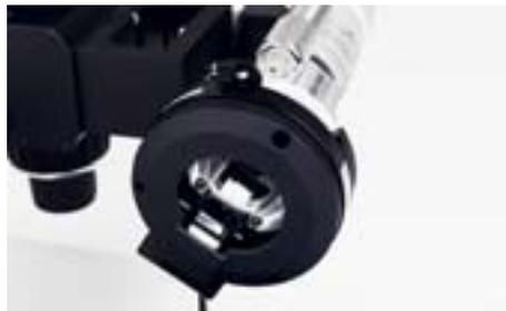
Der 360°-Drehkopf eines Leica Digitalmikroskops: Er liefert eine Rundumansicht der Probe, die ganz neuartige Betrachtungsmöglichkeiten eröffnet. Als Nebeneffekt des sich drehenden Bildes erhält der Anwender einen realistischen Eindruck der Dreidimensionalität der Probe.
