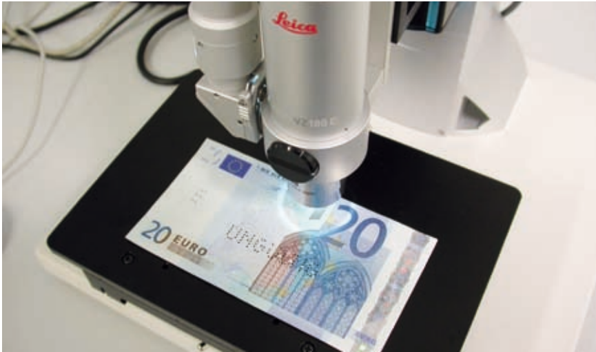
Abb. 2: Das Leica DVM5000 bei der Analyse einer Banknote. Mit Hilfe der hohen Vergrößerungen, der flexiblen Zoom-Optiken und der hohen Schärfentiefe können die Experten herausfinden, wie Falschgeld hergestellt wurde und zu welcher bereits bekannten Handschrift eine Fälschung passt.
