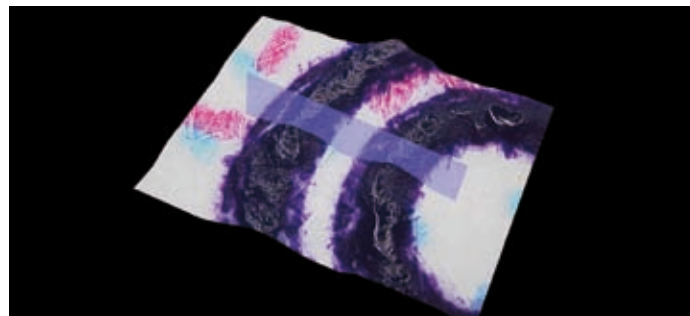
Abb. 6: 3D-Aufnahme des Stichtiefdrucks auf einer echten 500 Euro-Note. Durch das Profil wurde ein Schnitt gelegt.
