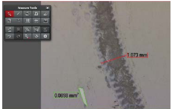
측정: 굽힘 너비 및 면적 측정 2D 이미지
