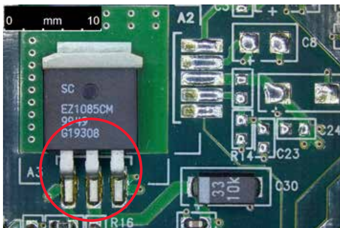
傾斜なし、XYステージ回転なし。電圧レギュレータのハンダ付けしたリード線（赤丸）。
