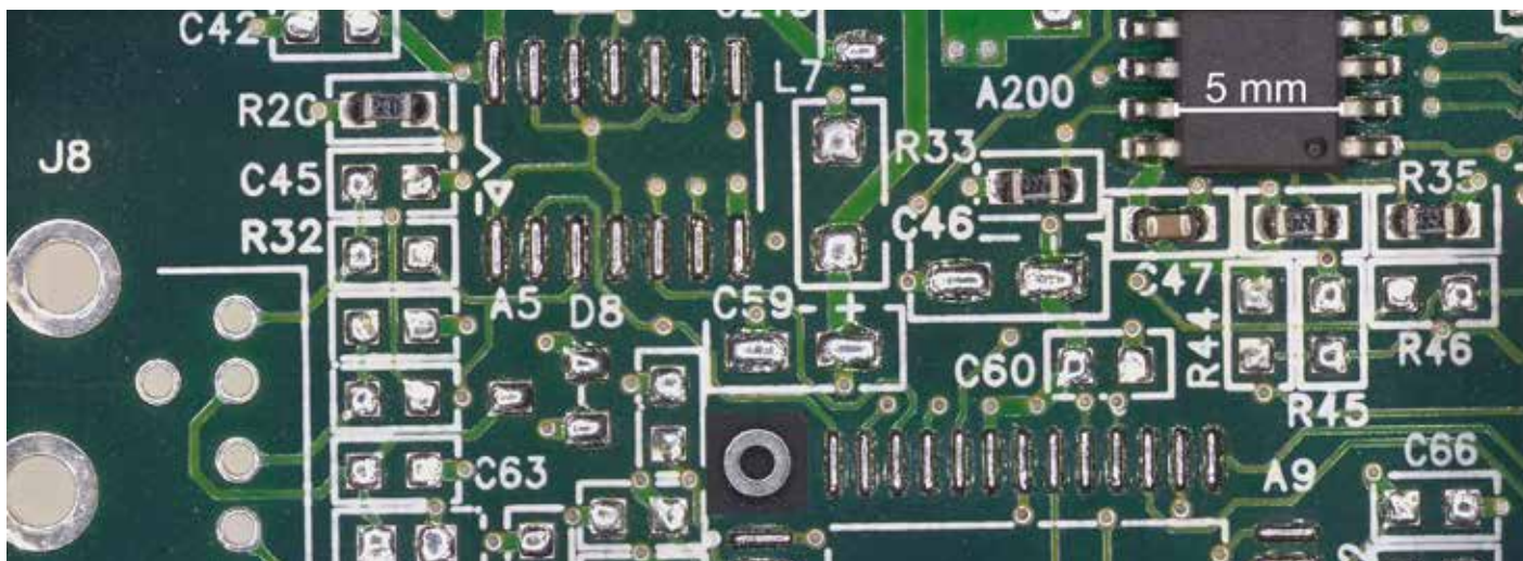
リング照明と透過光照明を併用。PCBのバイアホールを通過する光を確認できます。
