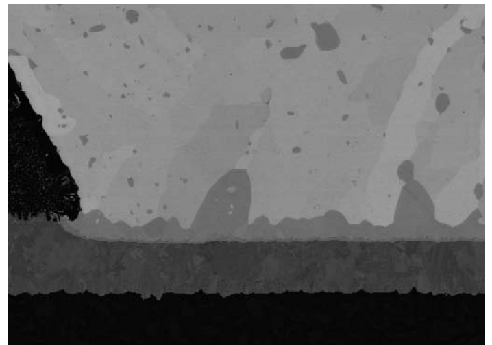
Ni/Coパッドのハンダボール断面のSEM画像
